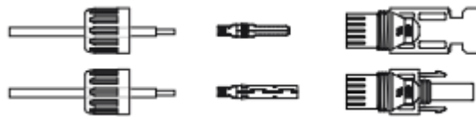
▲ Рисунок 4.8 Открутите накладную гайку от разъема
